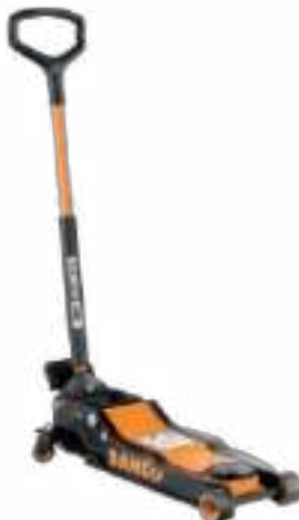
BH13000QA Gato perfil bajo 3T Altura: mín 90 mm ; máx 590 mm Sistema de pedal de aproximación rápido, alcanza altura máxima en 4.5 golpes.
